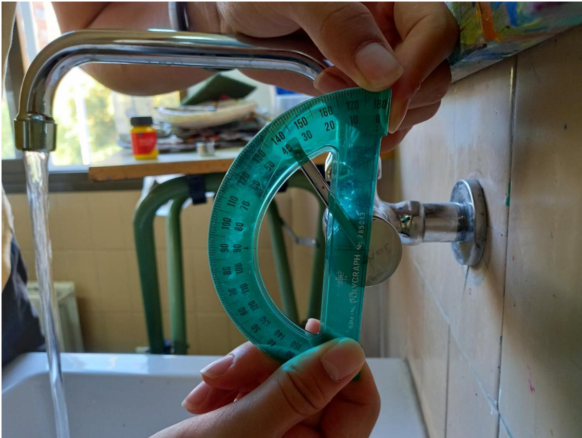
Imagen 6: Medida de la apertura del grifo mínima que produce aireación
