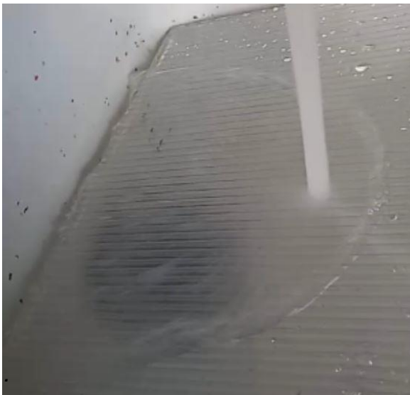
Imagen 4: Cuantificación de la salpicadura sobre la placa de policarbonato.
