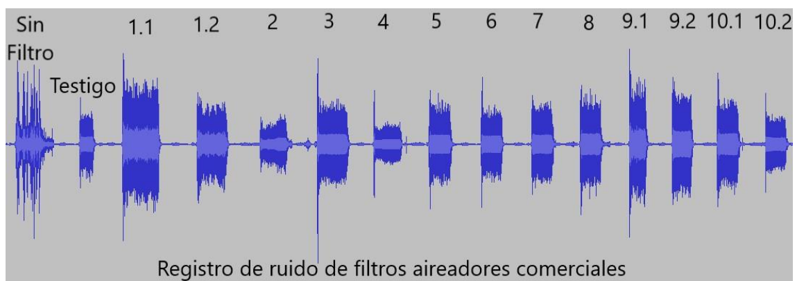
Imagen 8: Grafico de nivel ruido de cada filtro, obtenido con Audacity.
